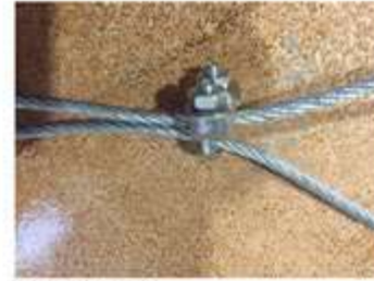
Perilla aprieta cables
